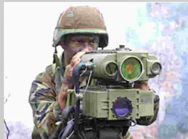
Laser Entfernungsmesser/Zielmarkierer Die nutzbare Reichweite von Lasersystemen ist meist größer als die Reichweite des unterstützten Waffensystems. Wenn die Laserbestrahlung rechtzeitig erkannt wird, kann Schutzwirkung noch durch Flugmanöver, welche eine Unterbrechung der Sichtverbindung bewirken, erreicht werden.
