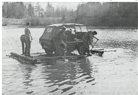
Abb. 1: Dieses Holzfloß mit den Abmessungen 4,5x2 m trägt fast 1.000 kg.
