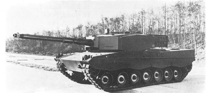
Oben: Prototyp des Kampfpanzers „Leopard 2-AV“ mit der 105 mm Panzerkanone L-7A3.
