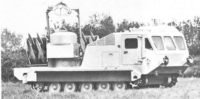
Flugabwehr-Raketenwerfer „Tracked Rapier“ auf einem abgewandelten Transportfahrzeug M-548.
