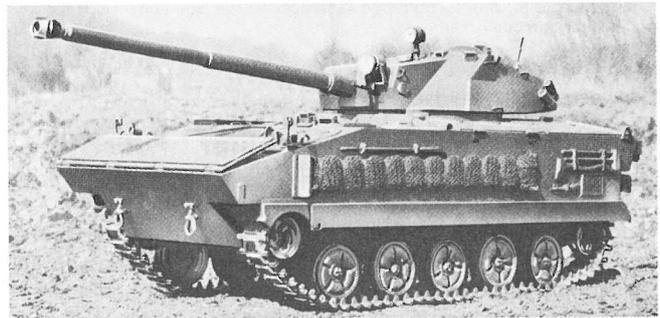
Bewaffung: 90 mm PzK mit 30 Schuß; ein koaxial gelagertes MG 7,62 mm; geplant ist der Einbau eines 12,7 mm MG als Zweitwaffe.
