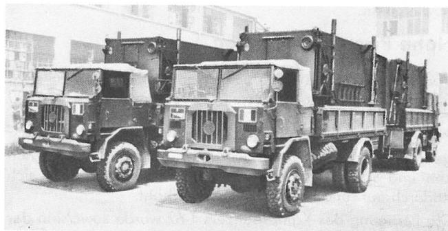
Mobile elektronische Datenverarbeitungsanlage der italienischen Armee, vorgesehen für eine Verwendung bei Stäben des Feldheeres; die vier Shelter werden auf LKW 5 t (4 x 4) CP/62 verlastet.
