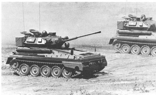
Spähpanzer „Scimitar“ F.V. 107 mit der 30 mm Rarden-Kanone. Mit dieser Kanone können sowohl Einzelschüsse als auch kurze Feuerstöße mit einer Kadenz bis zu 90 Schuß/min abgegeben werden.
