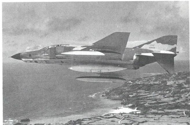
**Zweisitziger Aufklärer McDonnell Douglas RF-4C „Phantom“ II** der U. S. Air Force bei einem Überflugsflug mit Zusatztanks unter Rumpf und Tragflächen; die RF-4C sind unbewaffnet.
