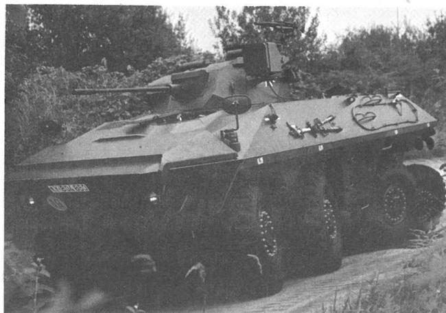
Spähpanzer „Luchs“ mit der 20 mm Bordkanone Rh-202 und einem 7,62 mm Maschinengewehr zur Fliegerabwehr.
