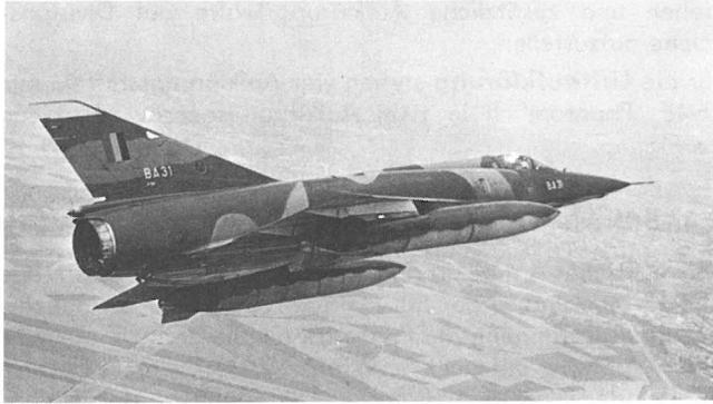
**Jagdbomber Dassault „Mirage“ 5-BA** der belgischen Luftstreitkräfte bei einem Übungsflug mit zwei Zusatztanks unter den Tragflächen. Die Höchstgeschwindigkeit dieses Jagdbombers ist 2 230 km/h in 12 000 m Höhe (Mach 2,1). Der Aktionsradius liegt zwischen 650 und 1 200 km; die Steigzeit auf 11 000 m Höhe beträgt drei Minuten.
