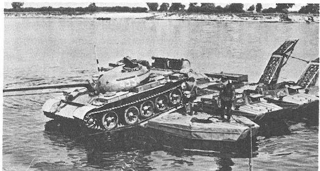
Sowjetische schwere Übersetzfähre GSP beim Entladen eines mittleren Kampfpanzers T-54. Verwendet wird die GSP-Fähre in den Übersetzkompanien der Divisions-Pionierbataillone und in den Übersetzverbänden der Armeepioniere.
