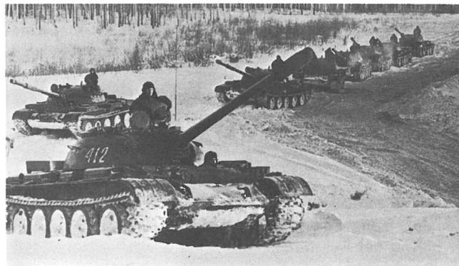
Die Kampfpanzer des Panzerbataillons als Zweite Staffel des MotSchützenregimentes folgen in Kolonne nach, um nach verschiedenen Seiten eingesetzt zu werden. Vorne ein Kampfpanzer T-54, dahinter neuere Panzer vom Typ T-62.
