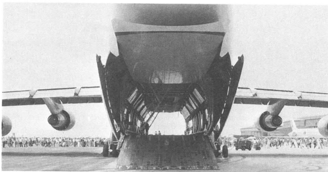
Strategischer Transporter Lockheed C-141A „Starlifter“ der amerikanischen Luftstreitkräfte. Besatzung: 4 Mann und 154 Soldaten oder 123 Fallschirmjäger oder 80 liegende Verwundete und 8 Sanitäter oder bis zu 32 136 kg Fracht.
