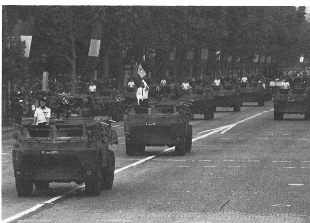
Zum Schutz der Fliegerhorste verfügt die Armée de l'Air über gepanzerte Mannschaftstransportwagen V.A.B. (Véhicule de l'Avant Blindée), bewaffnet mit einer 20 mm-Maschinenkanone und einem 7,62 mm-Maschinengewehr.
