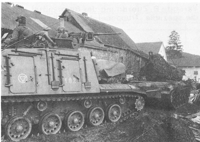
Einsatz eines Bergepanzers „Greif“ beim Abschleppen eines Jagdpanzers.
