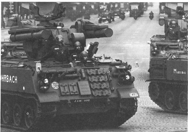
Panzerflugabwehraketensystem „Roland“ auf Schützenpanzer AMX-VTT des 57. Artillerieregiments (57ème Régiment d'Artillerie — 57ème R.A.).
