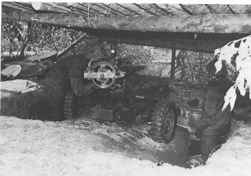
Der Zielvorgang ist bei der rückstoßfreien Panzerabwehrkanone 66 zeitaufwendig und verlangt eine intensive drillmäßige Ausbildung.
