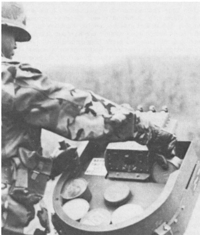
Tragbares Minenverlegegerät „Flipper“.
