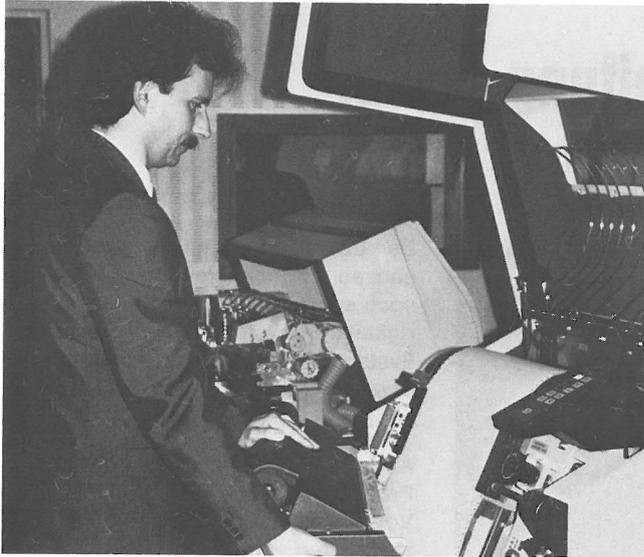
Justieren eines Schnelldruckers.
