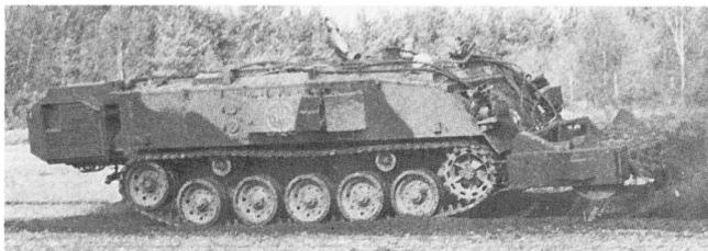
Das Minenräumergerät RACE („Rapid Area Clearance Equipment“).
