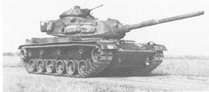
Kampfpanzer M-60A3; als letztes Glied der Kampfkraftsteigerung fehlt noch die Einführung eines Wärmebildgerätes.
