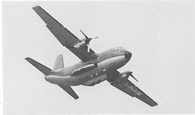
Die G.222 im langsamen Vorbeiflug mit abgestelltem rechtem Triebwerk (Propellerblätter in Segelstellung).
