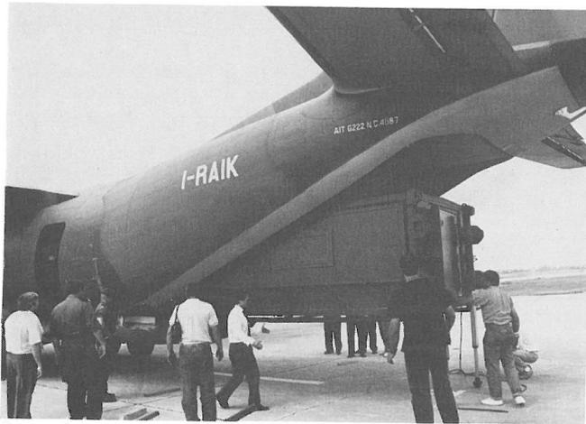
Das mobile Feldspital kann ohne Einsatz von Maschinenkraft über die Heckladerampe verladen werden. Links im Bild ist die linke der beiden hinteren Seitenluken zu sehen, die wahlweise für Fallschirmabsprünge verwendet werden können (Foto oben). Die für ein Transportflugzeug recht eleganten Linien der G.222 können den italienischen Designer nicht verleugnen (Foto unten).
