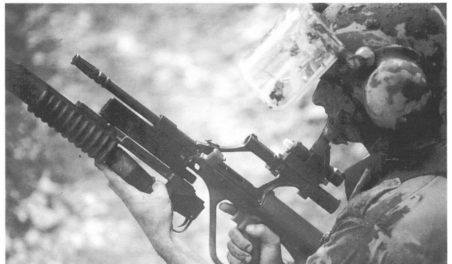
Laden des Granatgerätes M-203. Der Einzellader ist hier unter dem Lauf des Sturmgewehres 77 montiert.
