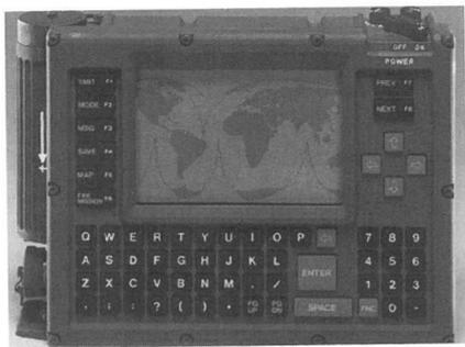
Datenendgeräte in Form eines "Handheld Terminals"; rechts mit Funkschnittstellenerweiterung zur Datenübertragung über drei FM-Kreise.
