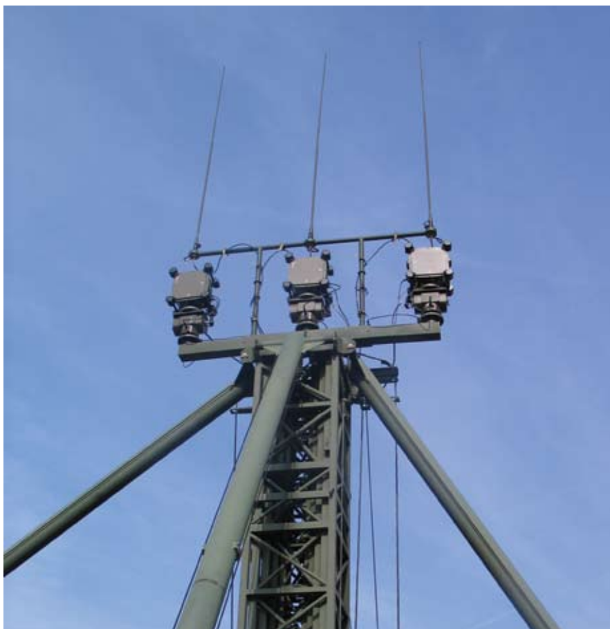
Das Antennensystem 25 Meter Automat mit RiFu- und VHF-Antennen
