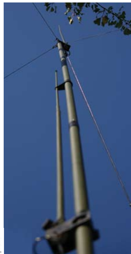
Antennenmast AMX 85 mit zwei VHF Breitbandantennen VHF30108VM
