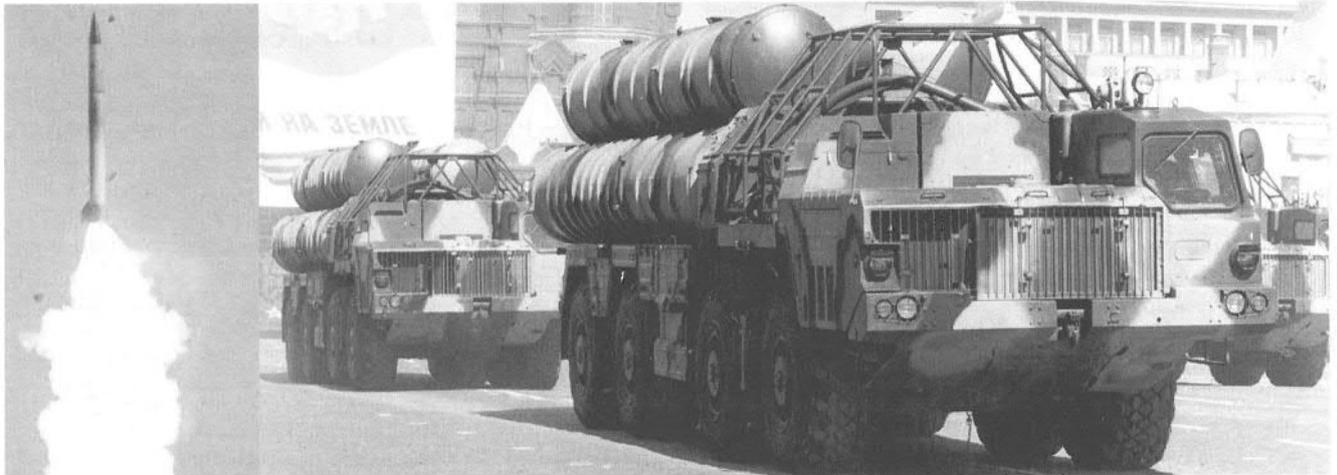
Transport- und Nachladefahrzeug für SA-10 (rechts). Vertikalstarttechnik (oben).
