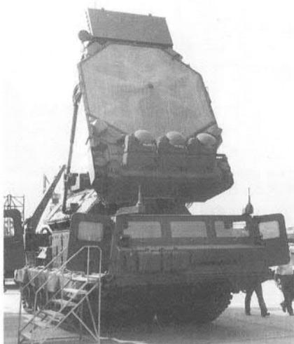
Mehrkanal-Lenkradar 9S32-1 (GRILL PAN).
