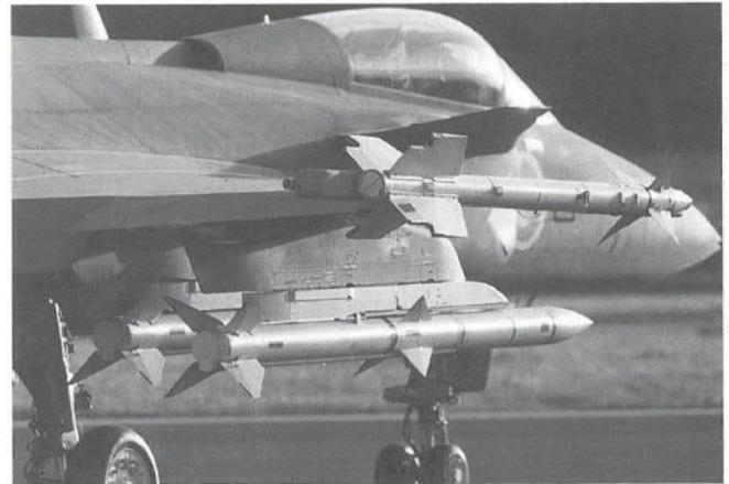
Das Kampfflugzeug JAS 39 "Gripen" wird mit Luft-Luft-Lenkwanne des Typs AIM-120 AMRAAM ausgestattet.
