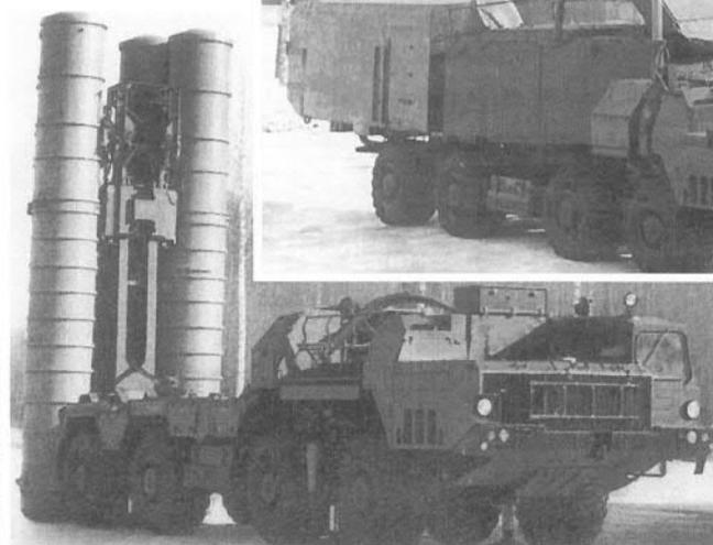
SA-10B: Batteriegefechtsstand mit Multifunktionsradar (FLAP LID) (oben) und Werfereinheit mit vier Flugkörpern (links).
