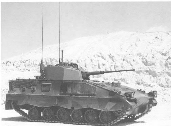
Der zweite Prototyp hatte um eine Laufrolle pro Fahrzeugseite weniger (Bild oben), verfügte aber noch über Schießluken für die Besatzung und über ein aufwendiges "Tür in Tür"-System am Fahrzeugheck (Bild rechts).
