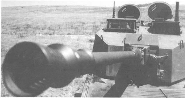
Der Zweimann-turm mit 30-mm-Maschinenkanone Mauser Modell F und 7,62-mm-Maschinengewehr 74.
