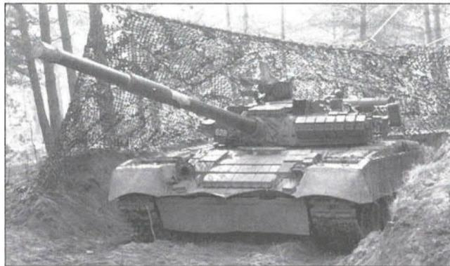
Der verbesserte Panzerschutz durch Zusatzpanzerungen bei den Panzern des ehemaligen Warschauer Paktes (im Bild ein T-80 mit Reaktivpanzerung) führte bei den NATO-Streitkräften zum Ersatz der auch im M-60A3 eingebauten 105-mm-Standardkanonen durch 120-mm-Glattrohrkanonen.
