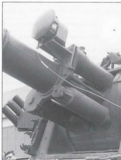
Das am Geschütz befestigbare Vo-Meßgerät dient der Bestimmung der Anfangsgeschwindigkeit der Granaten.
