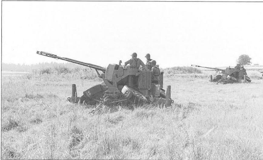
Die 3,5-cm-Z/FIAK; die schießenden Batterien bestanden aus je drei Feuerinheiten mit je zwei Geschützen und einem Feuerleitgerät.
