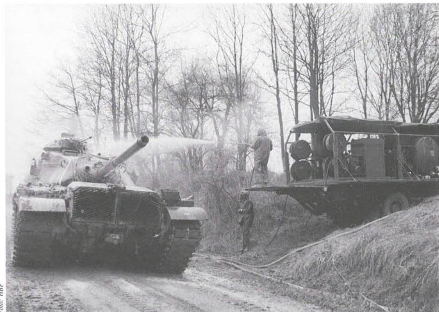
Dekontamination eines Kampfpanzers M-60A3Ö.
