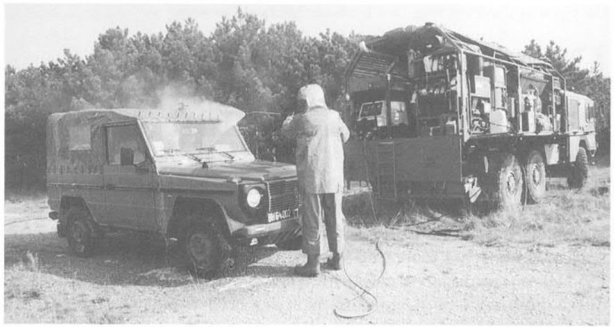
Dekontamination von Fahrzeugen mit der Ausstattung des mobilen Dekontaminations-Kraftfahrzeuges (Bild oben). Personen-dekontamination (Bild rechts).
