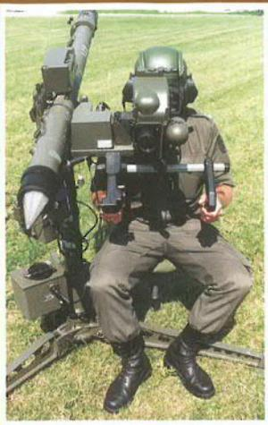
Im Zuge der Ergänzung der Geräteausstattung für das leichte Fliegerabwehrwaffensystem „Mistral“ wurde das Wärmebildgerät MITS 2 eingeführt. Dieses Gerät steigert die Auffassungreichweite der „Mistral“ auf bis zu 10 km und ermöglicht den Waffeneinsatz auch bei Nacht und schlechter Sicht.
