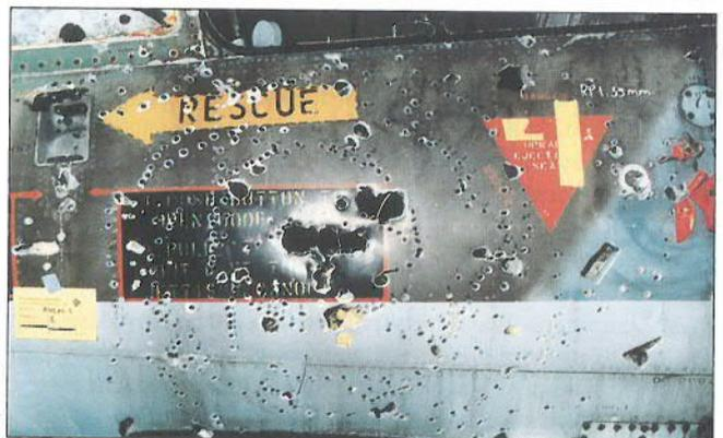
Wirkung der AHEAD-Munition am Vorderrumpfteile eines ausgehenden F-104 „Starfighter“.
