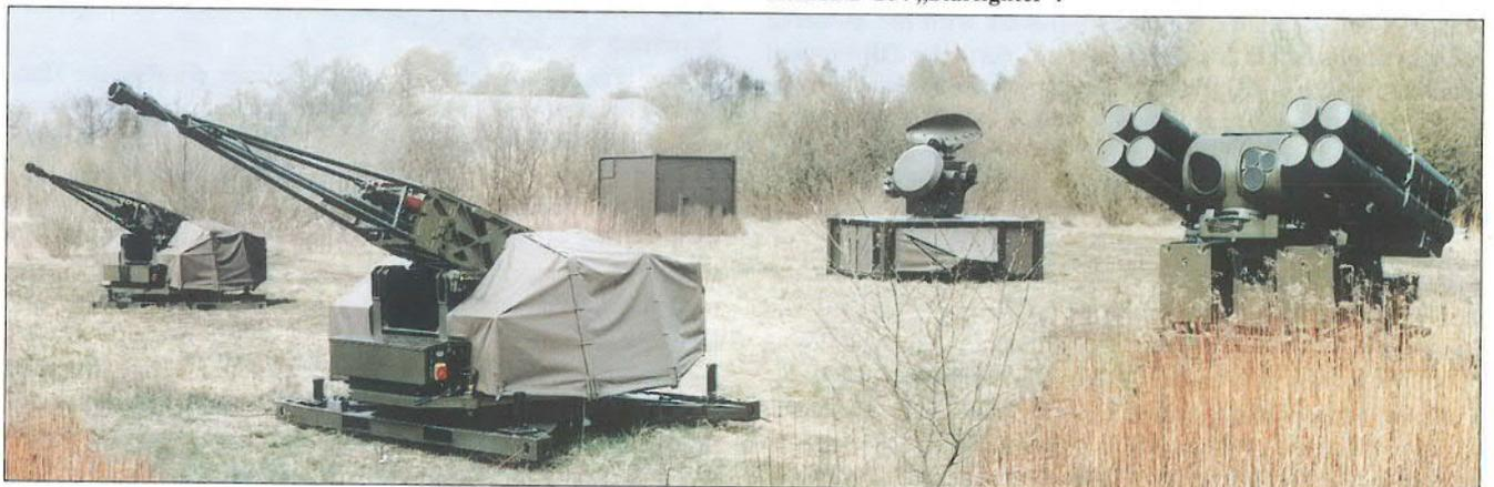
Eine Feereinheit „Skyshield“ 35/ADATS in Stellung: zwei Lafetten mit 3,5-cm-Revolverkanonen (links), ADATS-Werfer (rechts), Feuerleitgerät mit Sensoren und abgesetzter Gefechtsstand (Mitte).
