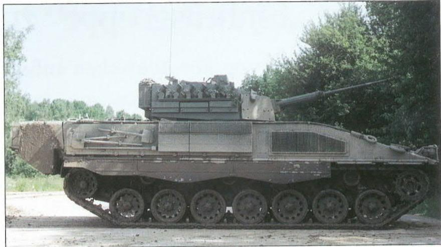
Der ASCOD Prototyp III von vorne, von der Seite (die sieben Laufrollen sind deutlich erkennbar) und in voller Fahrt im Gelände.
