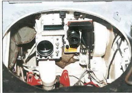
Linkes Foto: In der linken Turmhälfte befinden sich ein Monitor für das Wärmebildgerät (links) und das Kommandantenbediengerät (rechts). (Foto: Autor)
