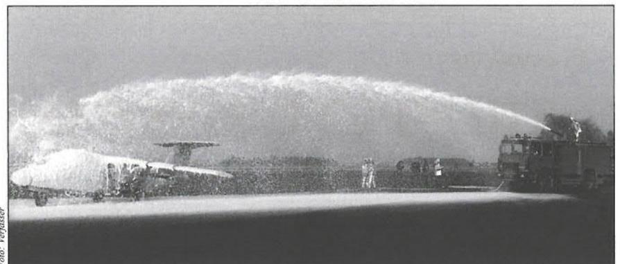
Einsatz des Flugfeld-Tanklöschfahrzeuges 4000 zur Kühlung des Cockpits. Um den Piloten zu retten, stehen dafür ab Ausbruch des Brandes nur 90 Sekunden zur Verfügung.
