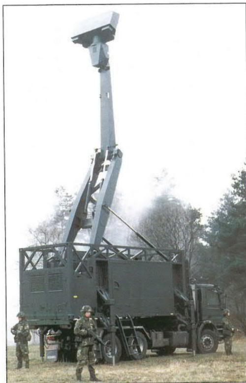
Das 3D-Suchradar „Giraffe“ AMB (Agile Multi Beam) wurde als Fliegerabwehrgefechtsstand für das schwedische Fliegerabwehrsystem RBS-23 „Bamse“ ausgewählt. Die moderne Phased-Array-Antenne befindet sich auf einem Antennenklappmast und ist in zwei Höhenstellungen einsetzbar.
