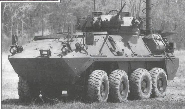
Im Hinblick auf den Zulauf der LAV-25 (links oben) dürften die restlichen „Bison“ zu Befehls-, Granatwerfer- und Bergepanzern umgebaut und die Transportpanzer „Grizzly“ (links unten) zu Pionierpanzern und gepanzerten Krankentransportern umgerüstet werden. LAV-25 *Combat Reconnaissance Vehicle* „Coyote“ mit Gefechtsfeldüberwachungsradar, Wärmebildgerät, Laser-Entfernungsmesser und Fernsehkamera auf einem 10-m-Teleskopmast (rechts).
