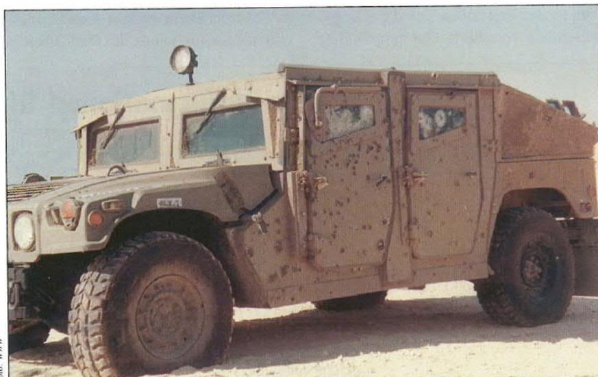
Die Sicherung der Zufahrtsstraßen zu israelischen Siedlungen erfolgt durch mobile Patrouillen mit leichten, gepanzerten Räderfahrzeugen (im Bild HMMWV mit Zusatzpanzerung).
