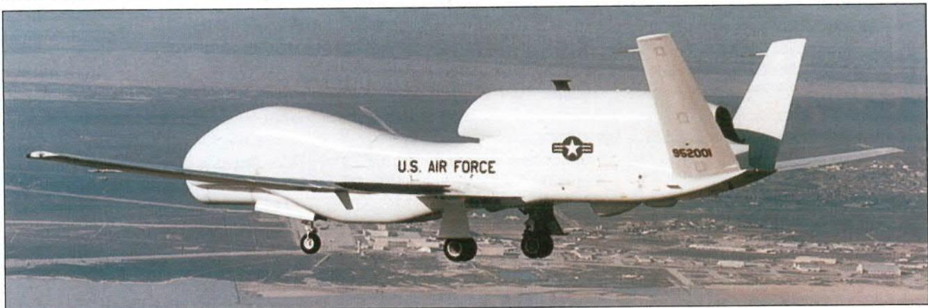
Der vom US-Hersteller Teledyne Ryan produzierte UAV „Global Hawk“ ist für den Einsatz in großen Höhen optimiert; die Verweildauer über dem Zielgebiet beträgt bis zu 40 Stunden. Die „Global Hawk“ wird derzeit massiv zur Informationsgewinnung über dem Irak eingesetzt. Foto: Teledyne Ryan
