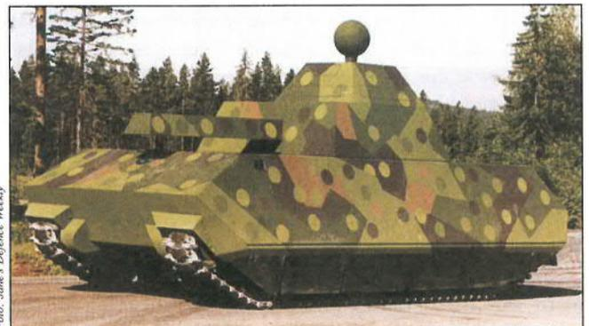
Der von Hägglunds Vehicle entwickelte SAT/Mark dient der Erprobung von Stealth-Technologien bei Kampffahrzeugen.
