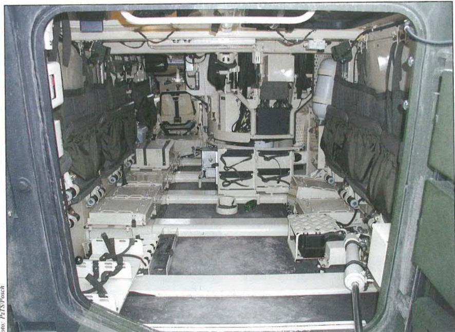
Innenansicht des „Ulan“ durch die Hecktüre gesehen: Gut erkennbar sind die am Wannen-dach aufgehängten hochgeklappten Sitze der Panzergrenadiergruppe.
