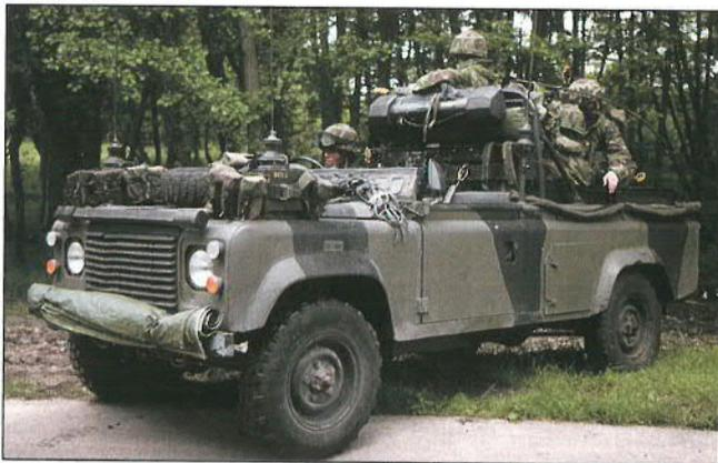
Funkfahrzeug Landrover FFR (*Fitted for Radio*).
