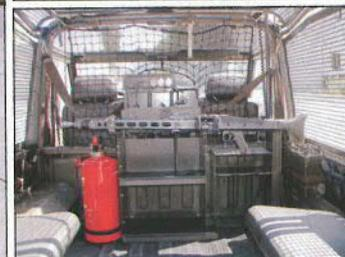
Die Ausrüstung der Patrouillenfahrzeuge umfasst u. a. eine am Überrollbügel montierte MG-Lafette, einen Arbeitsscheinwerfer, zwei abnehmbare Kabelschneider, ein Schutzgitter, das sich schutzkäfigartig über den gesamten Bereich der hinteren Ladefläche erstreckt, eine MG-Halterung im Fahrzeug und einen 9-kg-Schaumfeuerlöscher. (Fotos: Bundesheer)
