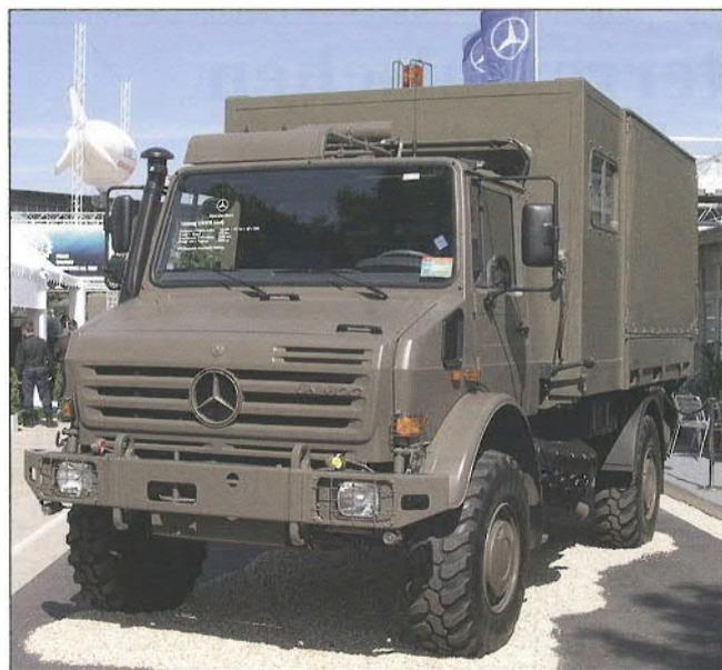
LKW (4 x 4) „Unimog“ U4000 von DaimlerChrysler in der Ausführung Pritsche Feldkabelbau für den Feldkabelbautrupp.
