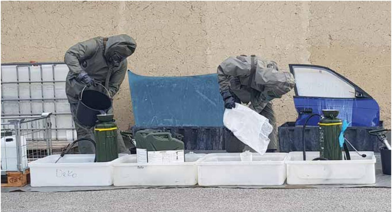
Abb. 3: Emulsionserzeugung mittels DS-10. (Foto: Hämmerle)
