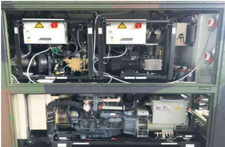
Abb. 3: Stromaggregat 40KVA, HDS 1200 & HD 4000. (Foto: Hämmerle)
