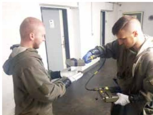
Abb. 2: Freimessen von radioaktiver Kontamination. (Foto: Foissy)
