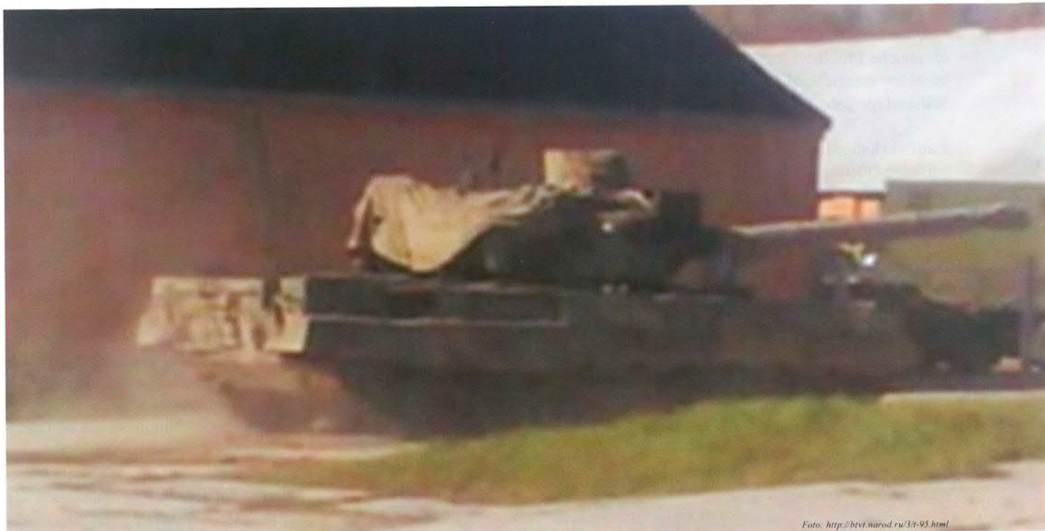
Heckansicht des Objektes 195; ein für die Gasturbinen typischer Abgasaustritt ist nicht erkennbar.
