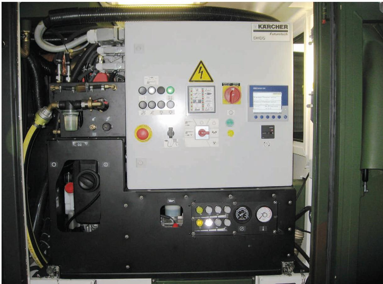
Abb. 3: Das Dampferzeugungs- und Hochdruckpumpenmodul (DHDS). (Foto: Hämmerle)
