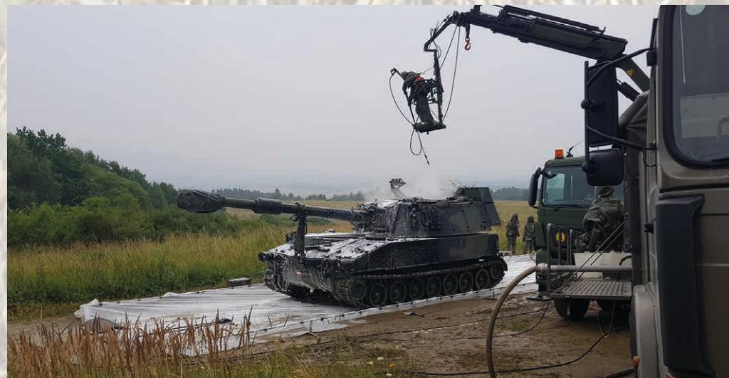
Abb. 7: Dekontamination eines Artilleriegeschützes (Panzerhaubitze M109) mit dem Dekon-System MAMMUT. (Foto: Hämmerle)
