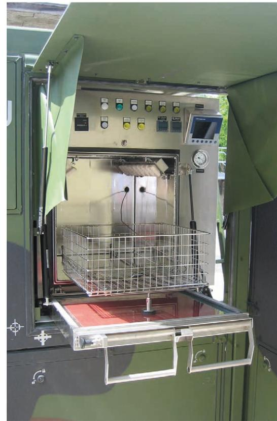
Abb. 4: Die Vakuumdekontaminationskammer (VDM 135). (Foto: Hämmerle)
