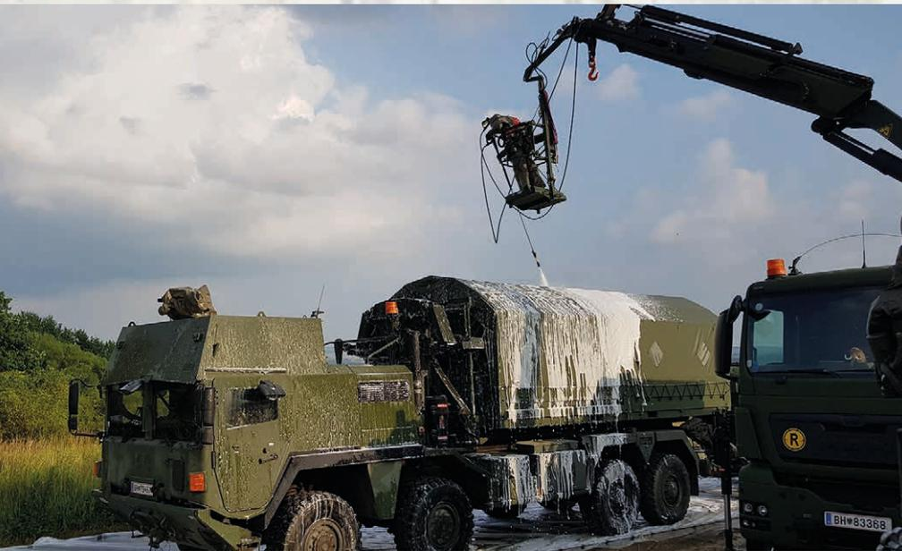
Abb. 5: Dekontamination eines LKW der Fliegerabwehrtruppe mit dem Dekon-System MAMMUT. (Foto: Hämmerle)
