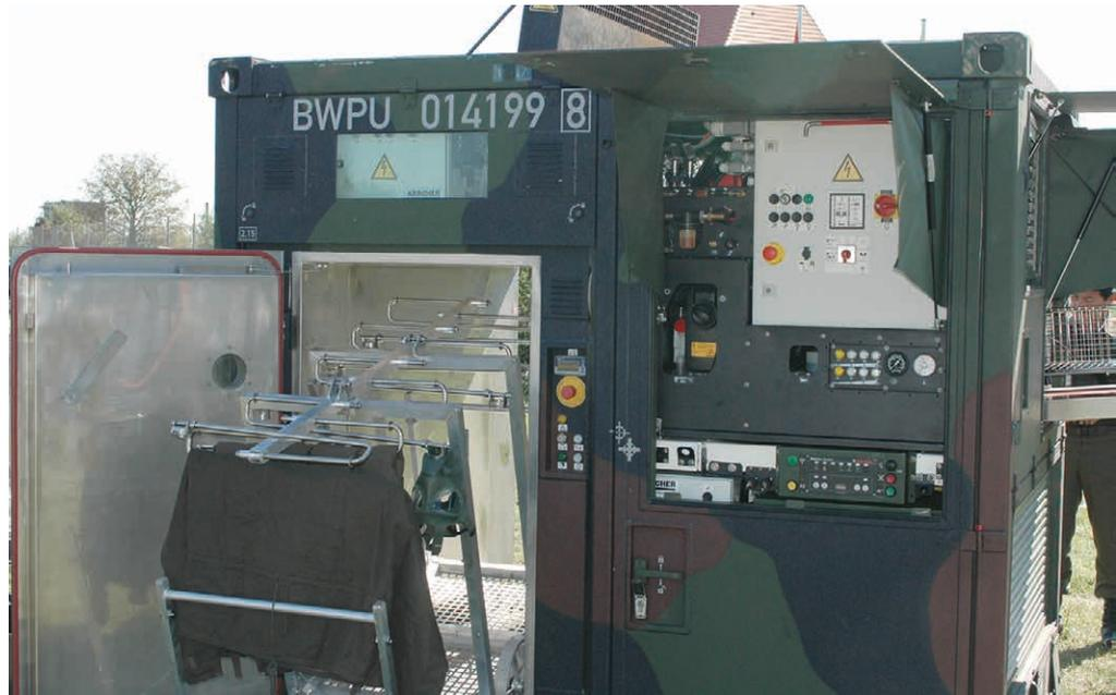
Abb. 2: Die Heißgas-/Heißdampfkammer (HGHD). (Foto: Hämmerle)
