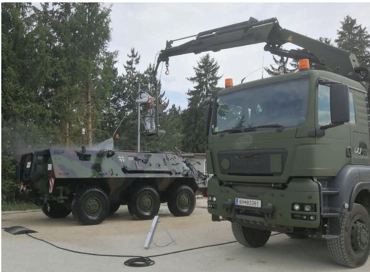
Abb. 2: Dekontamination eines Spürpanzers FUCHS. (Foto: Rath)
