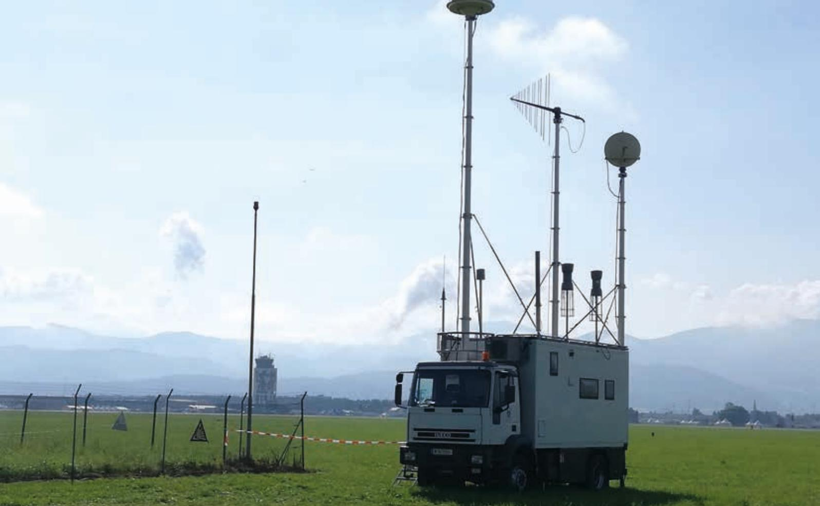
Großer Funkmesswagen der Funküberwachung Tirol am perfekten Aufstellungsort zur Überwachung des Veranstaltungsgeländes.
