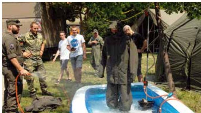
mit der Dusche konnte die Wasserdichtheit der Nässeschutzbekleidung getestet werden
