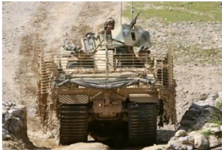
**Abbildung 20: BvS10 Viking mit Käfigarmierung gegen RPG-Treffer<sup>109</sup>**
