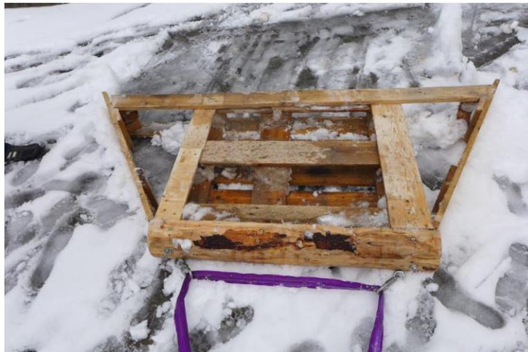
**Abbildung 44: Schleppflug zur Spuranlage mit ATV Quad<sup>166</sup>**
