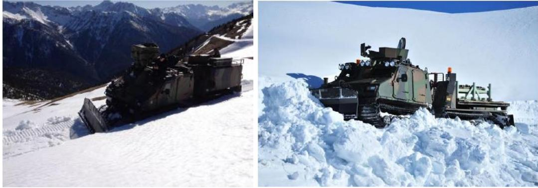
Abbildung 45: Schneerräumung/Wegeerrichtung mit Räumschild <sup>167</sup>
