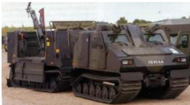
**Abbildung 16: Logistikversion mit Kran<sup>67</sup>**
