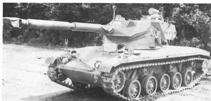
JaPzK-Prototyp mit Waffenstabilisation
