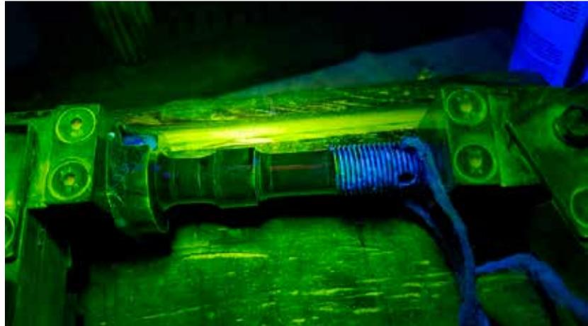
Abbildung 22: Heckbolzen SAAB 105 bei der Magnetinduktionsprüfung
