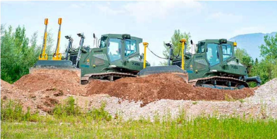
links Ausstattung mit 2D-Laser-Steuerung, rechts Ausrüstung mit 3D-GNSS-Steuerung
