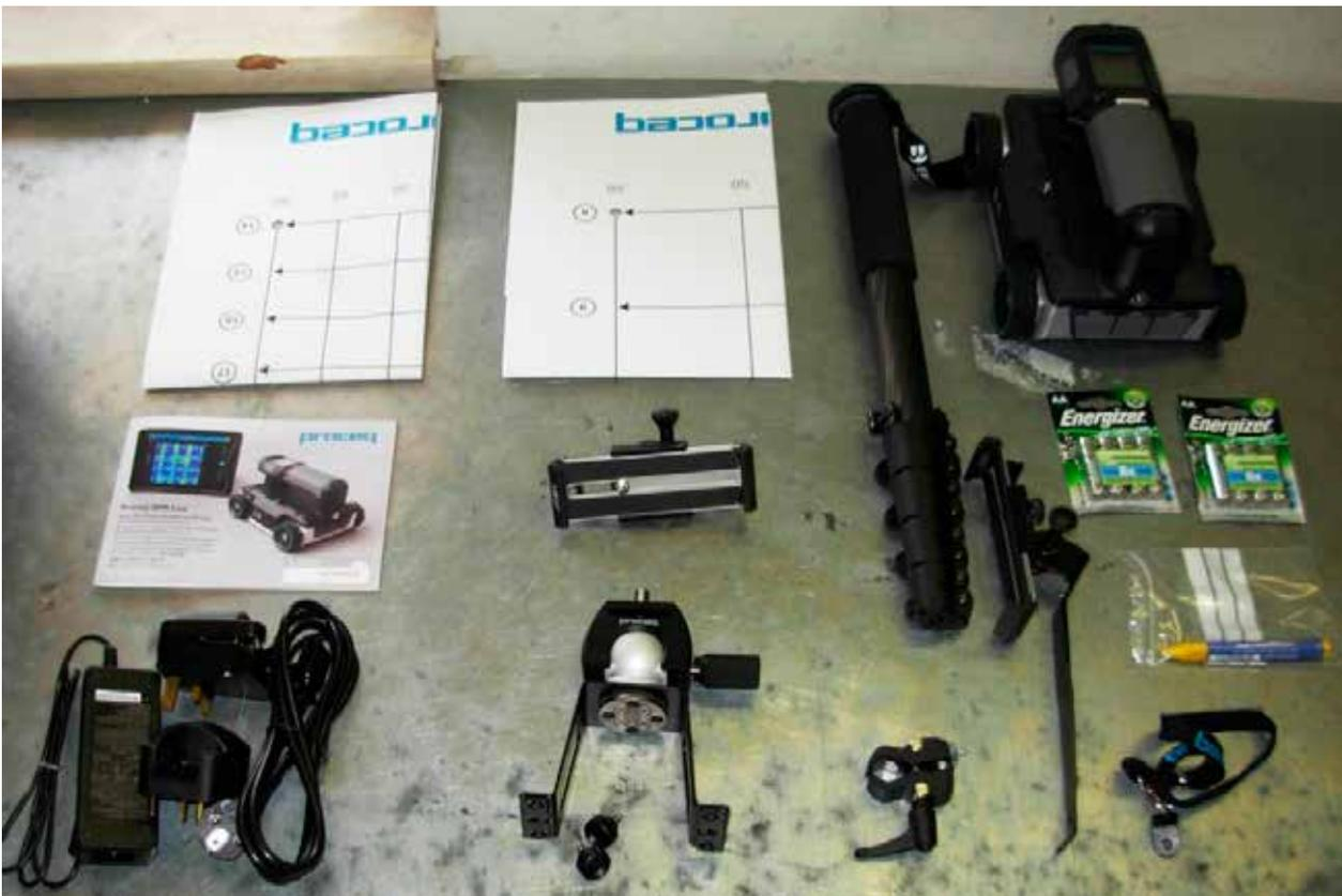
GPR Sonde des Beton- und Bewehrungsprüfsatzes
