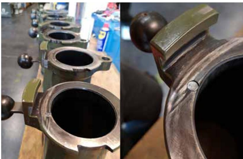
Abbildung 7: Bohrung mit eingeklebtem Magnet
