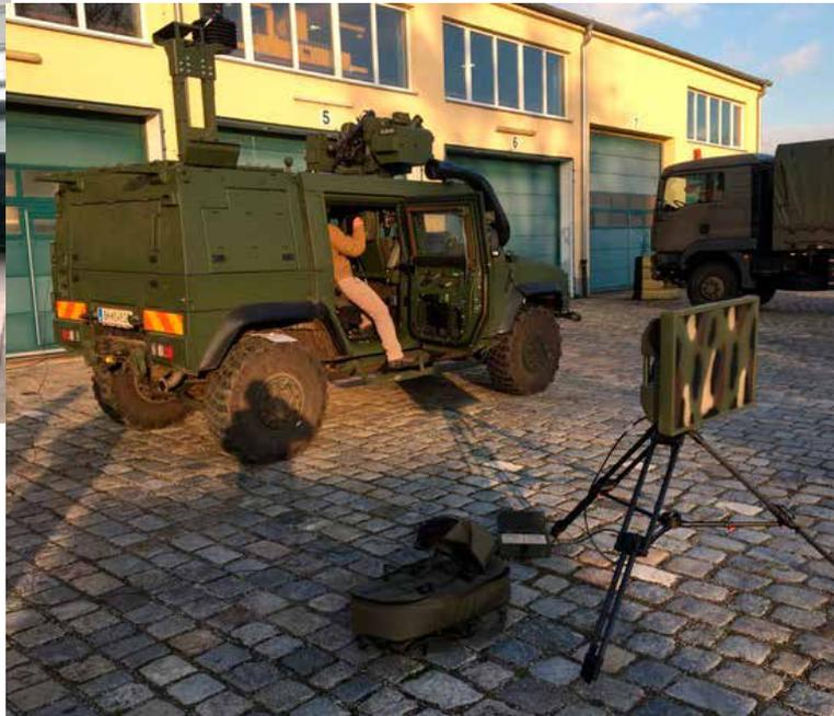
Test des abgesetzten Betriebes der Radarantenne
