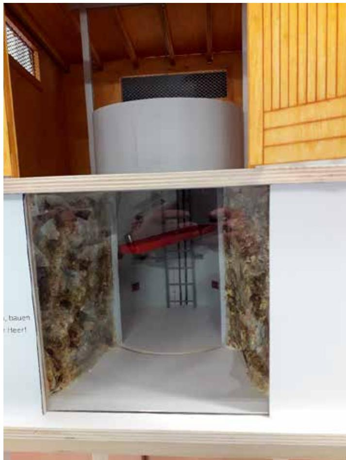
Modell des Rettungsschachtes mit Schachtkopf und Schachtfuß
