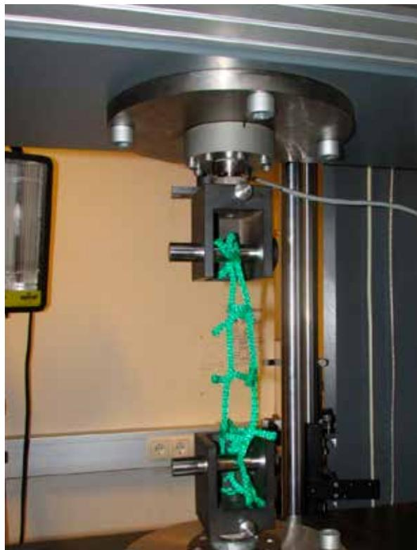
Abbildung 13 Prüfung von Transportnetz-Maschen
