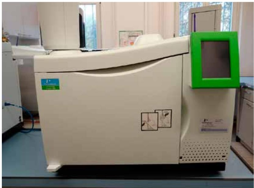
Abbildung 25: GC-Außenansicht (links oben Autosampler; grün umrandet GC-Display, Vorderseite Ofenöffnungsklappe)
