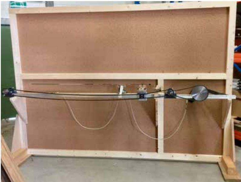
Die Versuchseinrichtung zur wiederholbar genauen Temperatur- und Bewegungsdatenermittlung des Zielerfassungsbereiches der Lenkwaffe IRIS für den EUROFIGHTER wurde weiterentwickelt.
