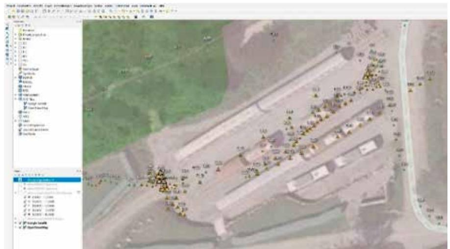
Abb 10: Mapping von radioaktiver Strahlung mittels Drohnenflug
