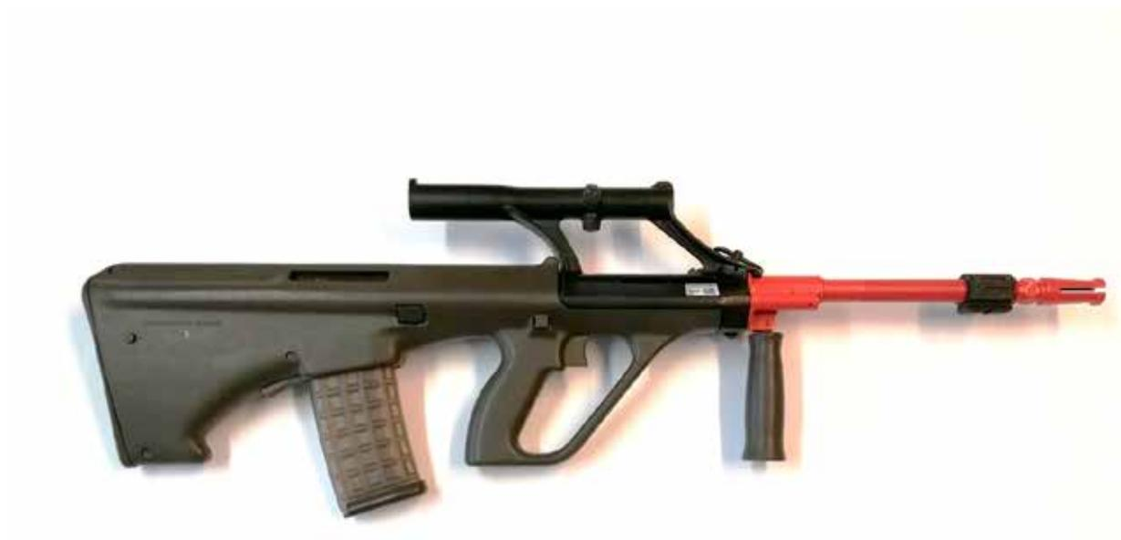
Abbildung 1: StG77 A0 mit Umbausatz inkl. modifizierter Schlageinrichtung
