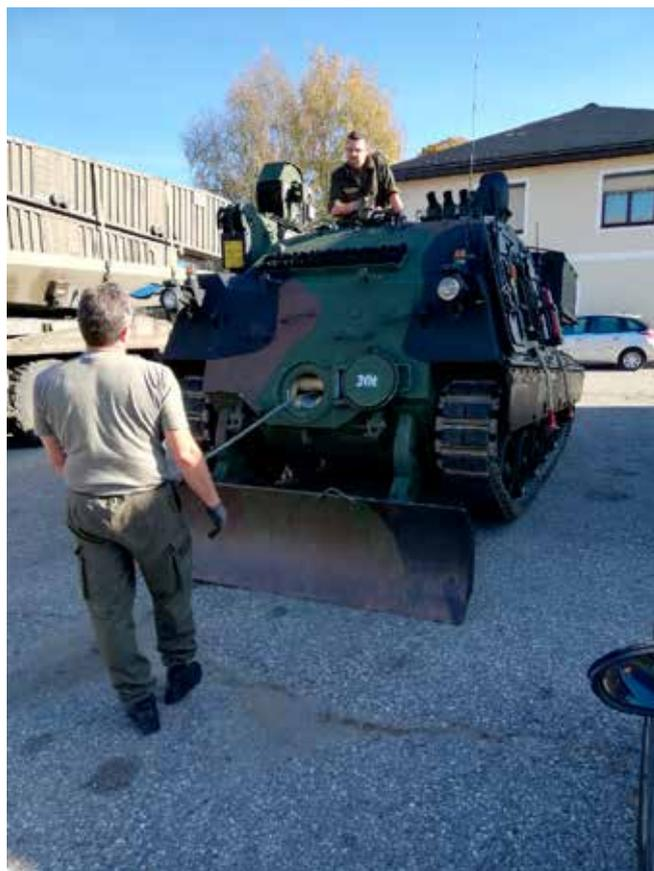
Mitarbeiter des HLogZ W und HLogS beim Prüfen der Seilwinde am BgePz GREIF
