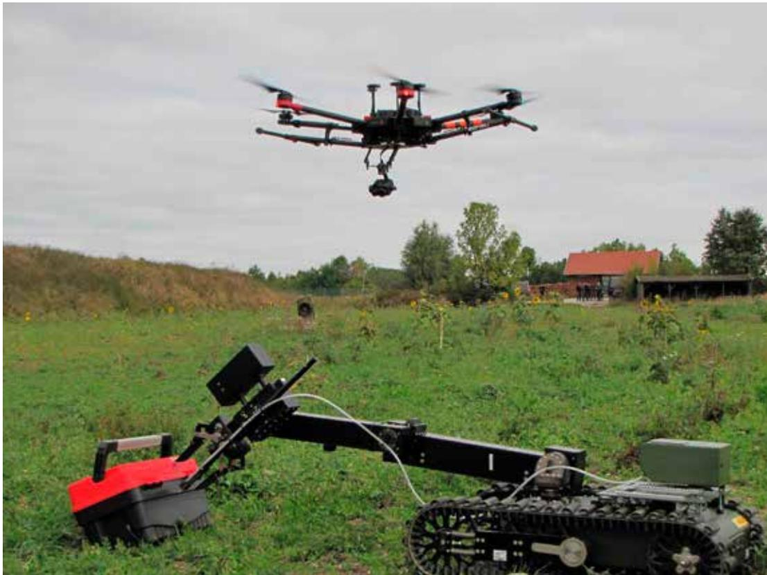
Abb 9: Sensorbestückte Lastendrohne zur Unterstützung des Roboters
