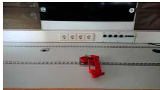
zusätzliche Nothammerbefestigung mit Airline System Adapter auf Arbeitstisch
