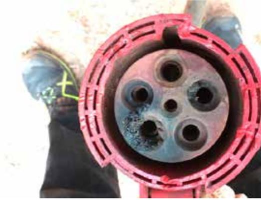
Abbildung 6: verschweißte 63A Kupplung Foto:
