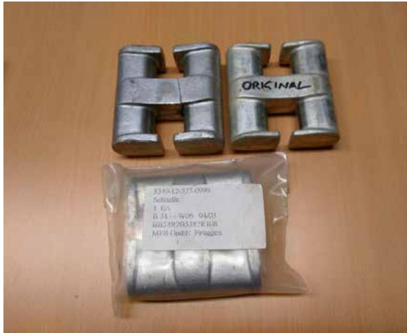
Abbildung 19: Gurtverbinder Faltstraßengerät
