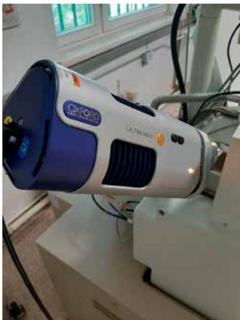
Abbildung 3: EDS Detektor Ultim max
