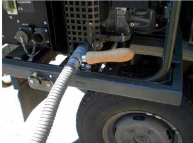
Metallgliederschlauch zur Ableitung der Auspuffgase am Auspuff angeschlossen
