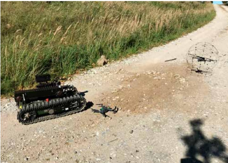
Abb 8: Käfigdrohne unterstützt Roboteroperation
