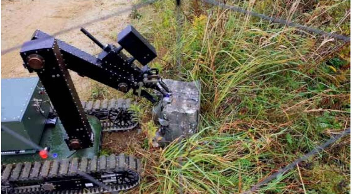
Abb 16: Roboter detektiert Explosivstoff an verdächtigem Objekt
