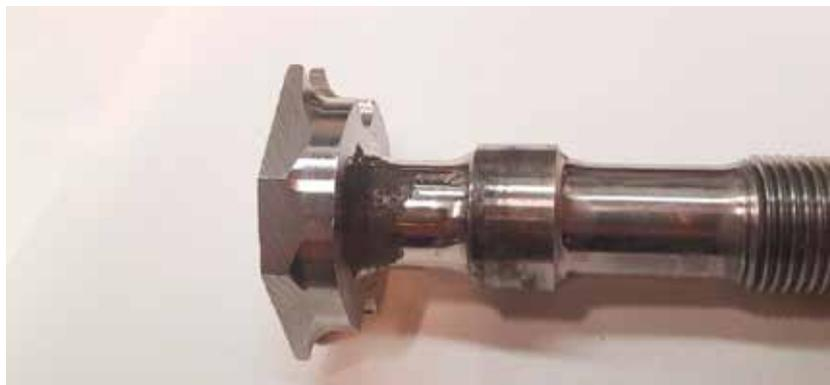
Abbildung 23: Heckbolzen SAAB 105 mit signifikanten Korrosionsstellen
