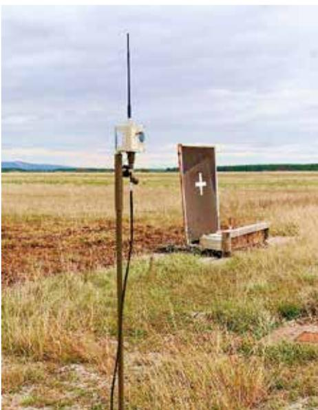
Abbildung 4: Zielscheibenbereich 900 m mit offenem Messbalken und Funkeinheit
