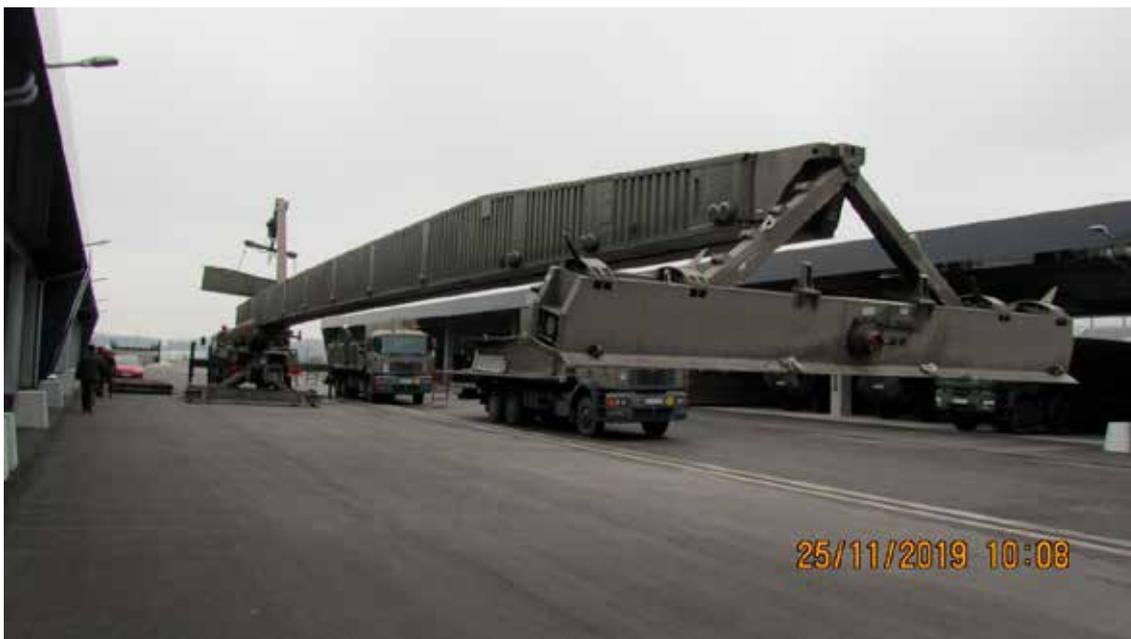
PiBr2000 System 06 PiB3 Abnahme Vorbauträger (VBT)-Antrieb nach Reparatur HLogZ S
