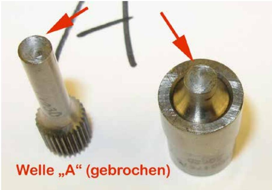
Abbildung 17: Gebrochene Nebenabtriebswelle ALOUETTE III
