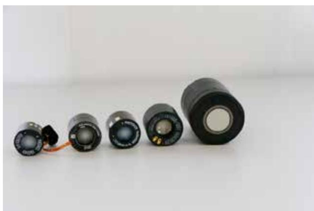
Abb. 6: Links Darstellung des Prüfmusters im Nachtsichtgerät. Das Balkenmuster 5 kann noch aufgelöst werden. Rechts sind unterschiedliche Typen von Restlichtverstärkerröhren dargestellt. Die ganz rechte Nachtsichttröhre ist im Fahrer-Nachtsichtgerät eingebaut, die 3 linken Röhren werden für am Helm tragbare Nachtsichtsysteme verwendet.
