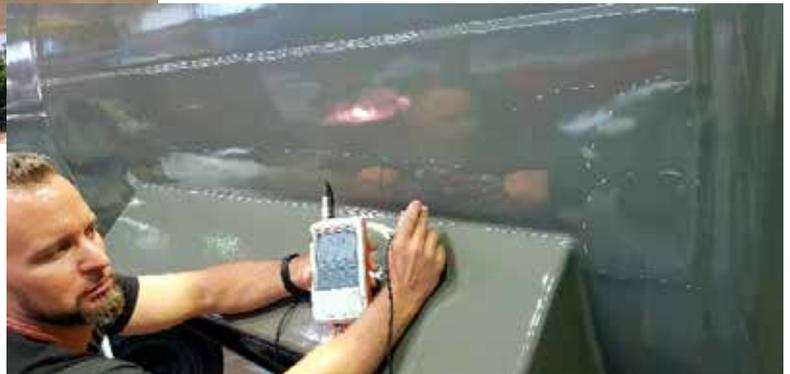
Beschichtungsprüfung des Lagerbehälters im Herstellerwerk LTD
