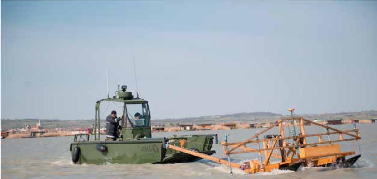
Erprobungsbetrieb für die nichtmetallische Schwimmplattform mit ArbBo zur Metalldetektion über Wasser
