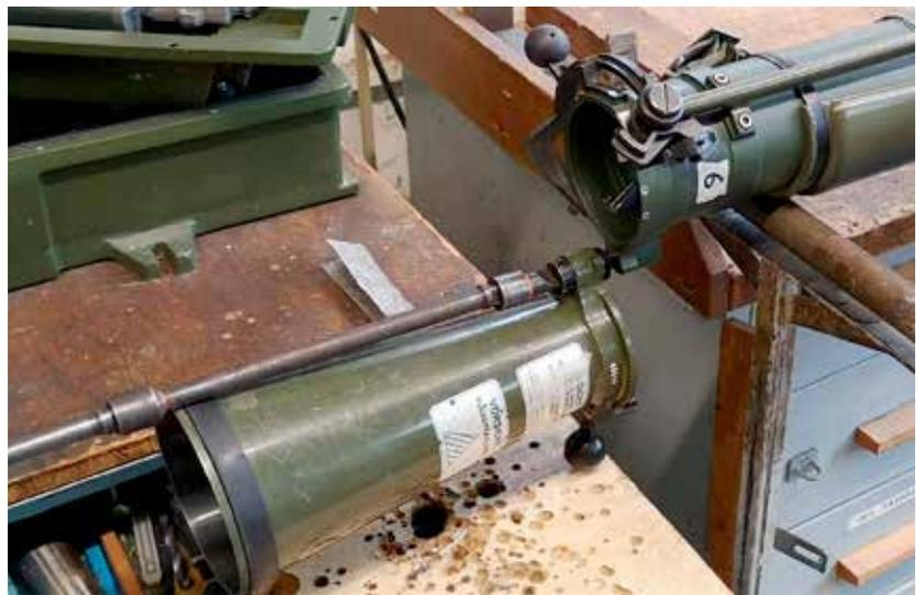
Abbildung 6: Demontage des Verschlusses
