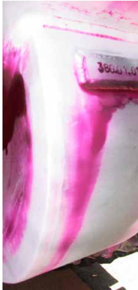
Abbildung 16: Seitenvorgelege Abdeckung ULAN: Farbeindringprüfung
