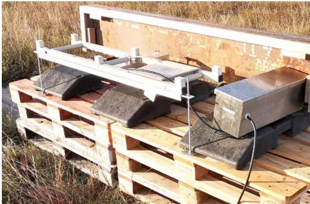
Abbildung 3: erhöhter Zielscheibenbereich 500 m mit offenem Messbalken und Akkukasten
