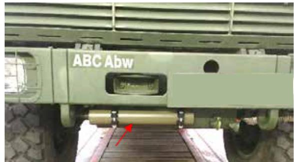
DINGO 2 AC mit neuer Dosisleistungssonde
