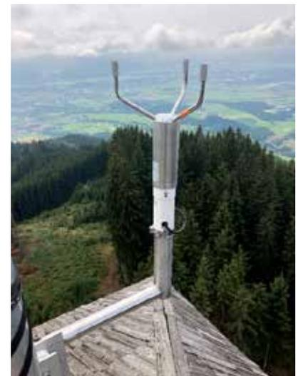
Abbildung 1: Ultraschallwindsensor am Tremmelberg - Foto: Windbacher/ESL
