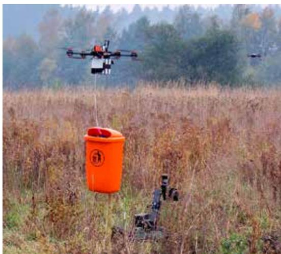
Drohne (Österreich) mit Chemischem Sensorsystem (Entwicklung Polen); rechts hinten Beobachtungsdrohne (ARWT - Österreich); vorne Detektionsroboter (ABCabwZ - Österreich)
