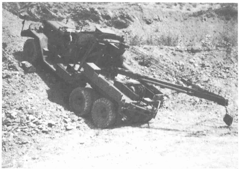
Als schweres Abschleppfahrzeug wurde im Panzerbataillon 33 das 6- Tonnen 6 x 6 Fahrzeug der Firma "Ward LaFrance" verwendet.
