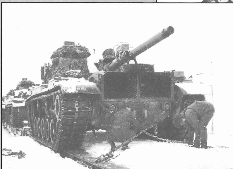
Eisenbahnverladung eines Kampfpanzers am TÜPL ALLENTSTEIG.
