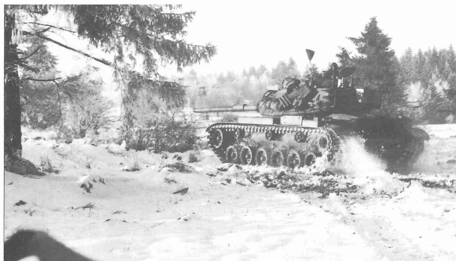
Im Mai 1988 werden die ersten kampfwertgesteigerten Kampfpanzer M60 A3Ö durch das Bataillon übernommen. Die Umrüstung aller M60 A1 auf M60 A3Ö wurde 1989 abgeschlossen, und das Kampffahrzeug stellt bis heute die Geräteausstattung des PzB 33 dar.
