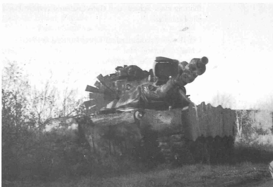
Erprobung einer Zusatztarnung für den M60 A1.
