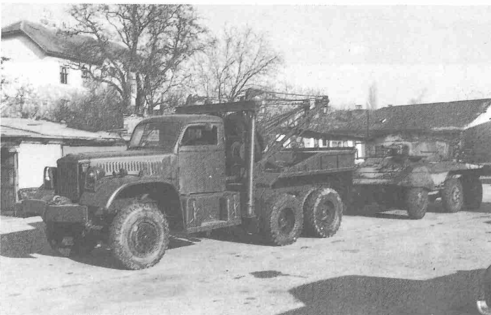
Der Krankkraftwagen T 969 der Firma "Diamond" wurde im Instandsetzungszug als Abschlepp- und Bergefahrzeug für Räderfahrzeuge verwendet.
