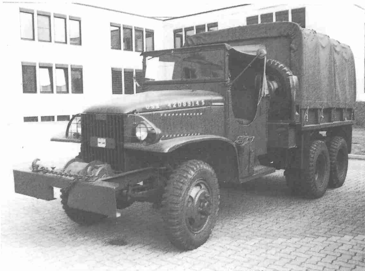
Geländegängiger Lastkraftwagen B 2 1/2 t GMC, Typ CCKW 352 (mit kurzem Radstand) wurde zum Transport von Mannschaft und Gerät eingesetzt.
