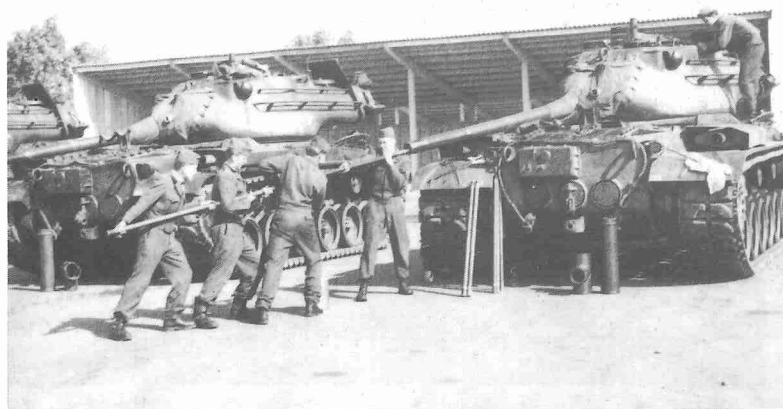
Rohrpflege am Kampfpanzer M-47. Der mittlere Kampfpanzer amerikanischer Bauart war 1959 bis 1965 beim PzB 33 eingesetzt.
