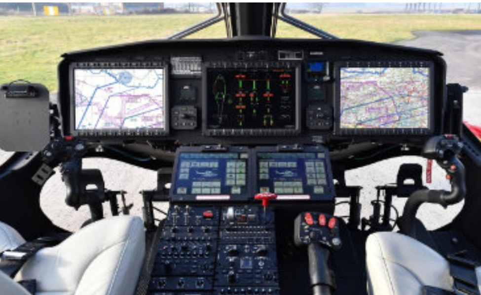
Der AW169M verfügt über ein topmodernes digitales Cockpit für dessen Moving Map System IMG sämtliche Geodaten aufbereitet (Grafik: Leonardo)
