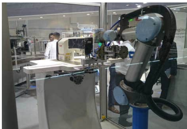
◀ Eine Doppelsteppstichmaschine wird bereits von einem Roboterarm bedient
