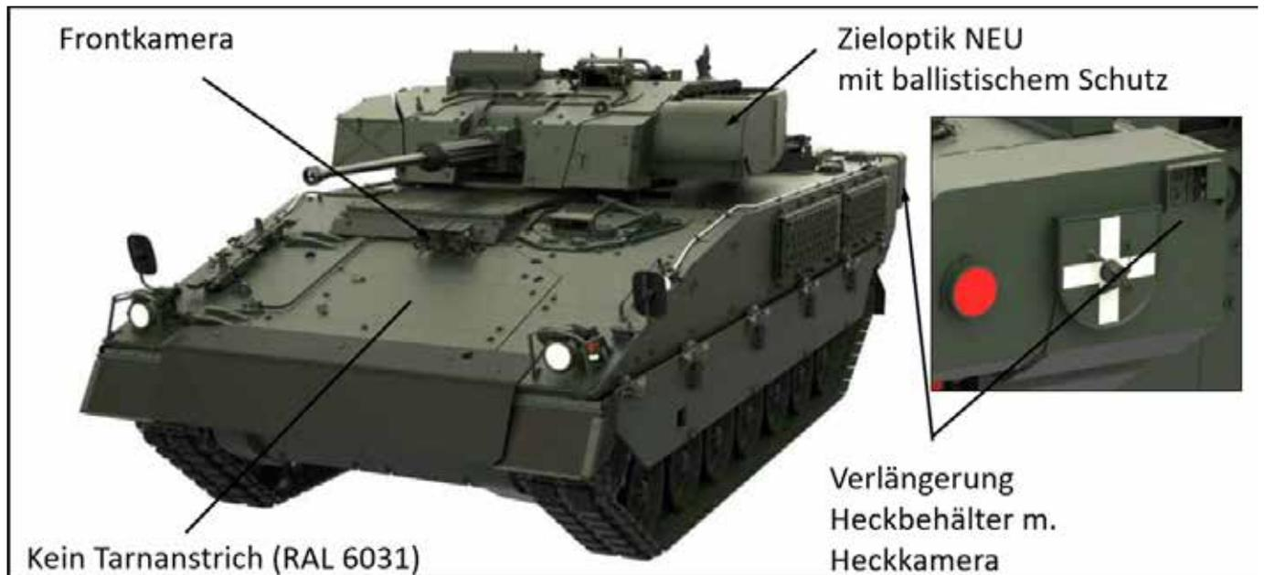
Abb.: Erkennungsmerkmale des SPz ULAN NV (Quelle: GDELS, Bearbeitung durch den Verfasser)
