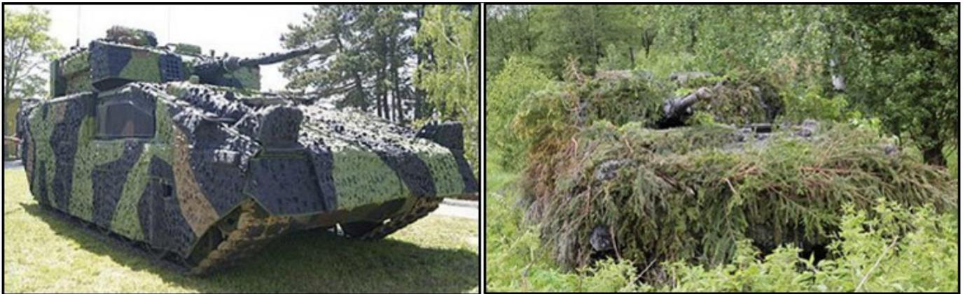
Abb.: Das Mobile Camouflage System (MCS) dient als Wärmebildschutz und zur Aufnahme von natürlichem Tarnmaterial (Quelle: Bundesheer)
