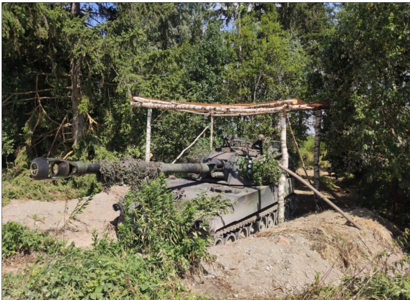
Abb.: Geländeverstärkung zur Reduzierung der Bedrohung durch Drohnen
