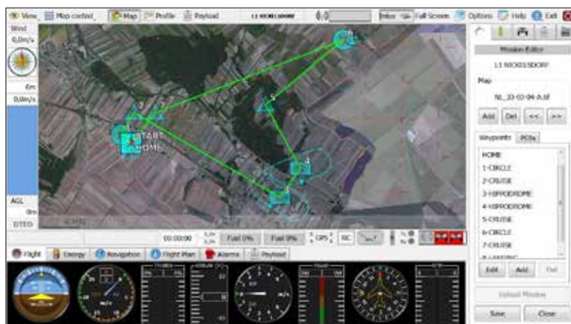
Abbildung 3: Missionseditor des Systems TRACKER. Der Bediener erstellt die Mission, die das unbemannte Lfz nach dem Start selbständig fliegt. Dadurch kann sich der Bediener vollständig auf seine Hauptaufgabe, nämlich Beobachten mithilfe des Sensors, konzentrieren.
