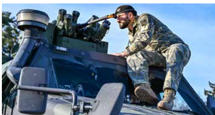
Beim Justieren werden Optik und Waffe auf einen Punkt gebracht
