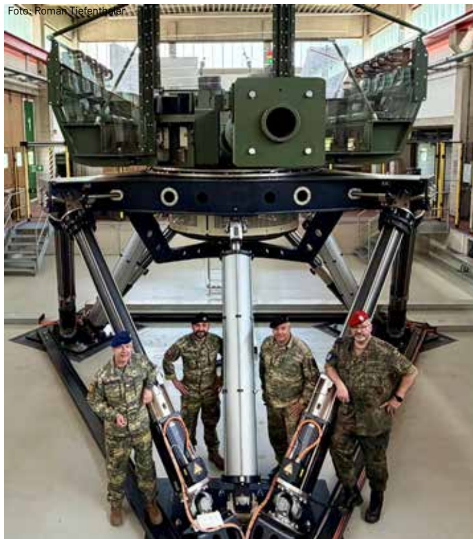
Der Turminstandsetzungssimulator ermöglicht es, realitätsnah und ohne Materialverschleiß die komplexe Wartung, Fehlerdiagnose und Reparatur der Waffensysteme und Turmstrukturen zu trainieren.
